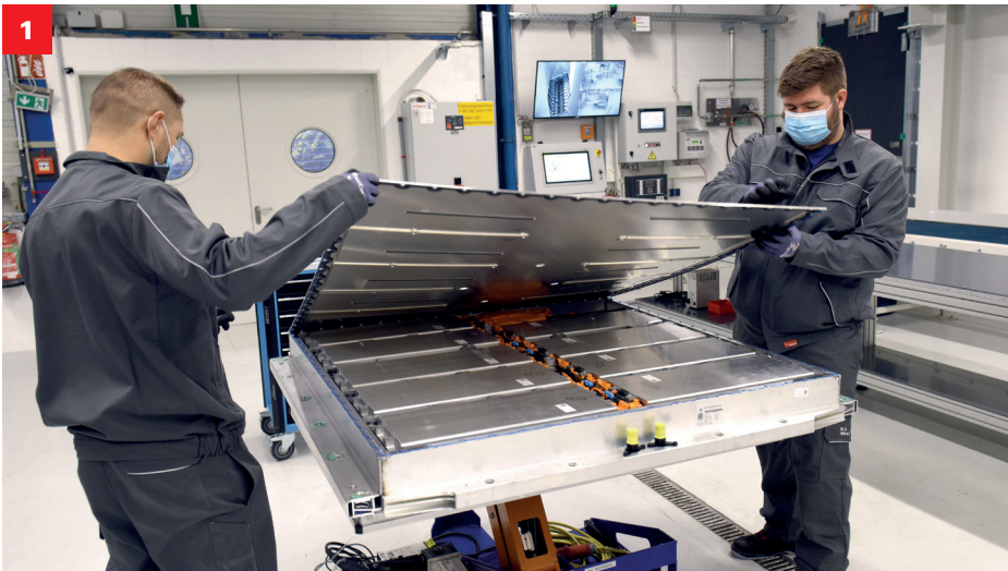
1 Die Hochvoltbatterie zerlegen stellt für die Werkstatt-Spezialisten ebenfalls keine unüberwindbare Herausforderung dar. Allerdings sind auch hier die Ersatzteile wie Zellmodule nicht bei allen Herstellern erhältlich. Foto: VW 2 Sobald an Hochvoltkomponenten gearbeitet wird, müssen Sicherheitsvorschriften eingehalten und speziell isoliertes Handwerkzeug verwendet werden. Die Mitarbeitenden müssen sich entsprechend weiterbilden, um die Herstellervorgaben zu erfüllen. Foto: Mercedes 3 Auch bei den Batteriemangementsteuergärten und Zellüberwachungsmodulen hapert es bei vielen Herstellern bei der Ersatzteilversorgung. Ohne die Ersatzteilversorgung werden BEV, Plug-in-Hybrid und Hybridfahrzeuge zu Wegwerfprodukten. Foto: Mercedes
